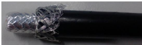
3. Remova a lâmina de alumínio deixando visível a camada insulada
