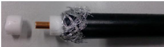
5. Coloque e crimpe o pino do núcleo.
