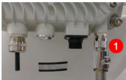
2. Use fita de autofusão, assegurando a vedação contra água, para selar o conector.
